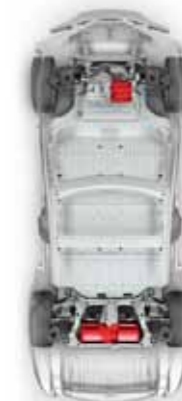
Uložení baterie a motorů v podvozku elektrického auta
