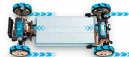
Uložení baterie a motorů v podvozku elektrického auta
