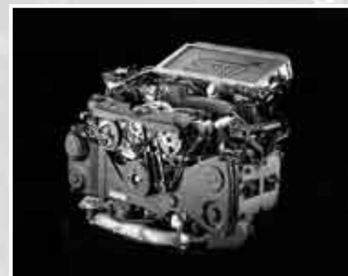
Srdce vozu: jen dva litry objemu, zato 195 kW [265 koní] výkonu
