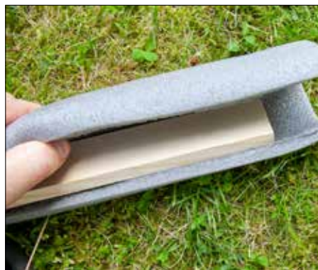
Čepel i záštitu obalíme Mirelonem. Na konci necháme izolaci přechuhovat, aby nevznikly ostré rohy.
